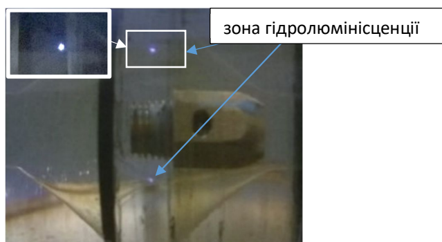
Рис. 3 – Світловипромінювання в кавітуючому потоці мінерального масла ( рух рідини з права на ліво, \Delta p=15 бар, t=20^\circ\text{C} )
