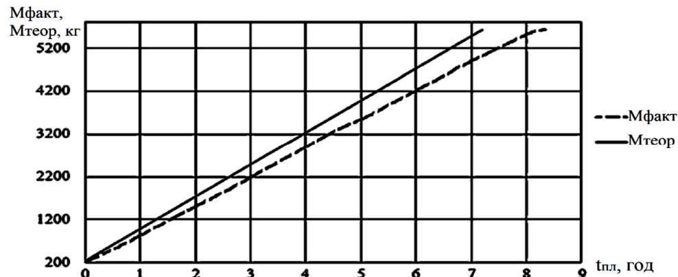
Рис. 2. - Залежності зміни маси зливу в часі при роботі оператора електронно-променевої установки ( M_{\text{факт}} ) та запропонованої механотронної системи керування плавкою титану ( M_{\text{теор}} )
