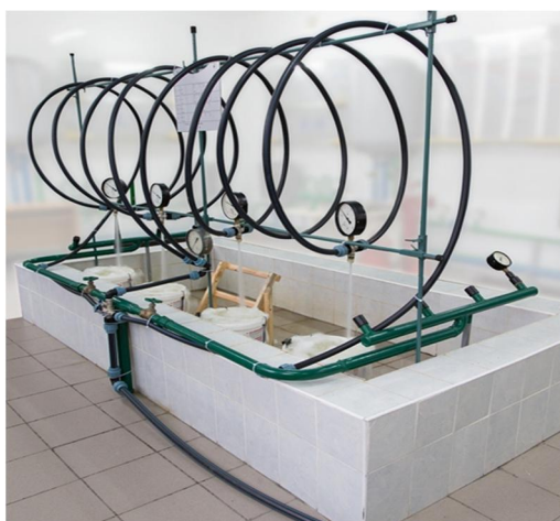
Рис. 1 - Стенд, що дозволяє моделювати течію рідини із змінною вздовж потоку масою
